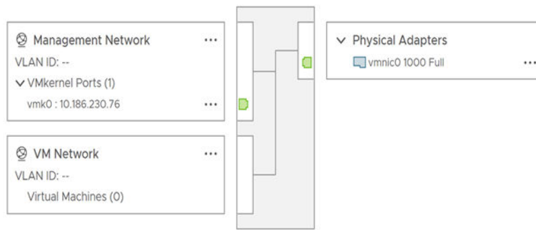
图 2-2. 将 VMkernel 和虚拟机连接到网络的标准交换机拓扑图
